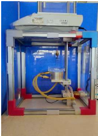
Figura 1. Dispositivo construido para la medición de la tensión superficial por el método del anillo du Noüy
